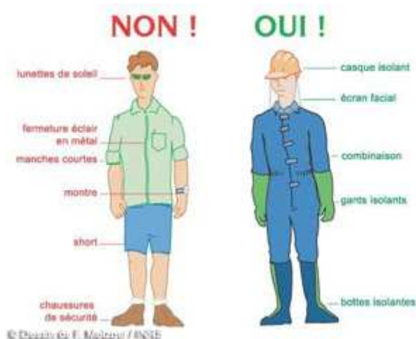
EPI pour les interventions sous tension
