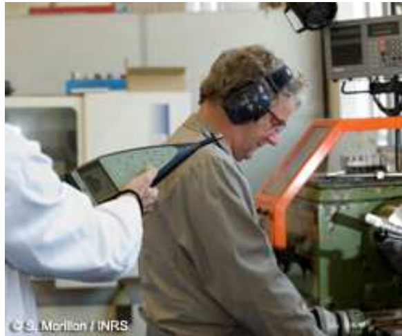
Les niveaux sonores sont mesurés avec un sonomètre.
